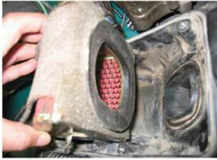
**产生后果：**空滤器滤芯堵塞，发动机功率下降，油耗增加，严重的空滤器滤芯损坏，粉末灰尘进入发动机内，造成汽缸、缸体和活塞环磨损。
